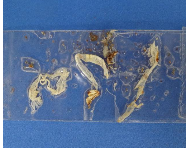
工事に関連したと考えられる異物
